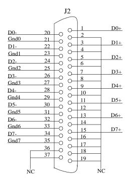
Figure 5. DB37 input connector J2
